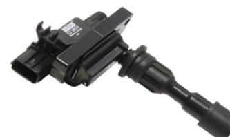
L'alta tensione prodotta dalla bobina viene trasmessa alle candele d'accensione, a seconda del tipo d'impianto d'accensione , dell'anno della vettura e del modello. Le vetture datate hanno un distributore d'accensione meccanico che garantisce l'alta tensione alle diverse candele. Con l'introduzione dell'accensione elettronica il distributore non è più presente perchè esiste una specifica bobina collegata direttamente su ogni singolo cilindro/candela.
